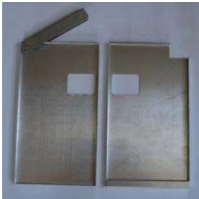
Obrázek 2: Dvě části Kovové kryogenní kazety pro kryovaky NK500, spodní do které se vkládá vaky vlevo a horní vpravo.
