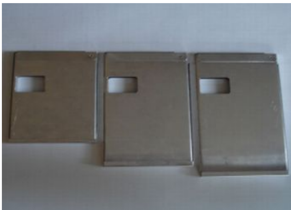
Obrázek 1: Kovové kryogenní kazety pro kryovaky, NK2500-750
